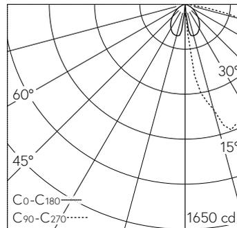
LED 4000 K 13.1 W 1625 lm-h / CIE Flux 35 73 97 100 100 / A30 nach DIN 5040
