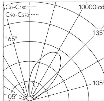
LED 4000 K 53 W 5045 lm-h / CIE Flux 22 43 56 0 100 / E84 nach DIN 5040
