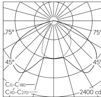
LED 3000 K 43.1 W 5069 lm-h / CIE Flux 41 79 97 100 100 / A30 nach DIN 5040
