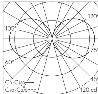
LED 4000 K 15 W 973 lm-h 222°/222° / CIE Flux 10 34 64 49 100 / C11 nach DIN 5040
