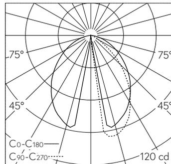
LED 3000 K 2.7 W 155 lm-h / CIE Flux 59 88 98 100 100 / A50 nach DIN 5040
