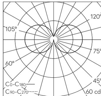
LED 3000 K 4.8 W 450 lm-h 178° / CIE Flux 13 37 66 48 100 / C11 nach DIN 5040
