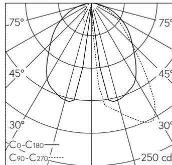
LED 3000 K 4.9 W 365 lm-h / CIE Flux 54 84 97 100 100 / A50 nach DIN 5040
