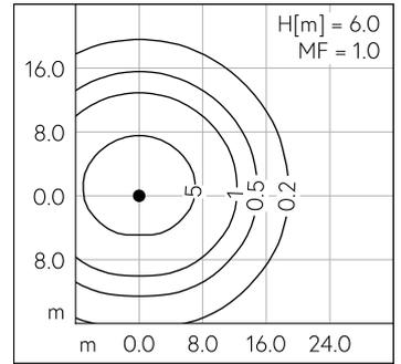
LED 4000 K 25.8 W 2591 lm-h H = 5 m / CIE Flux 37 73 92 97 100 / A30 nach DIN 5...
