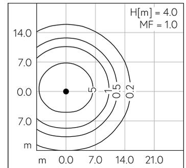
LED 4000 K 25.8 W 2591 lm-h H = 4 m / CIE Flux 37 73 92 97 100 / A30 nach DIN 5...
