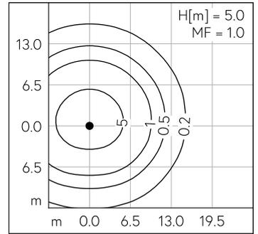
LED 3000 K 18 W 1508 lm-h H = 4.5 m / CIE Flux 36 71 92 97 100 / A30 nach DIN 5...
