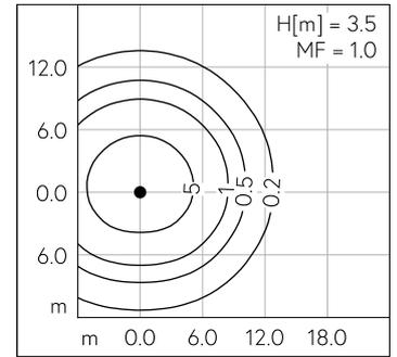
LED 3000 K 18 W 1508 lm-h H = 3.5 m / CIE Flux 36 71 92 97 100 / A30 nach DIN 5...
