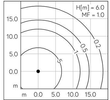
LED 4000 K 25.8 W 2611 lm-h H = 5 m / CIE Flux 38 73 93 97 100 / A30 nach DIN 5...
