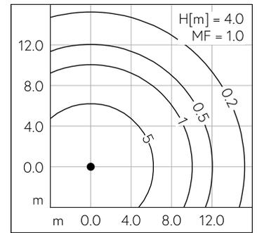
LED 4000 K 25.8 W 2611 lm-h H = 4 m / CIE Flux 38 73 93 97 100 / A30 nach DIN 5...
