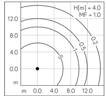
LED 3000 K 25.8 W 2543 lm-h H = 4 m / CIE Flux 38 73 93 97 100 / A30 nach DIN 5...
