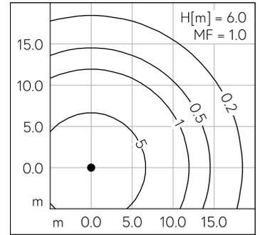
LED 3000 K 25.8 W 2543 lm-h H = 5 m / CIE Flux 38 73 93 97 100 / A30 nach DIN 5...
