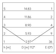
LED 4000 K 2.7 W 101 lm-h 112° / CIE Flux 0 0 0 0 100 / E83 nach DIN 5040
