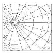
LED 4000 K 28.8 W 2575 lm-h / CIE Flux 16 41 69 50 100 / C11 nach DIN 5040
