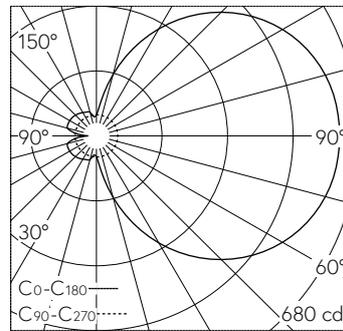
LED 3000 K 28.8 W 2477 lm-h / CIE Flux 16 41 69 50 100 / C11 nach DIN 5040
