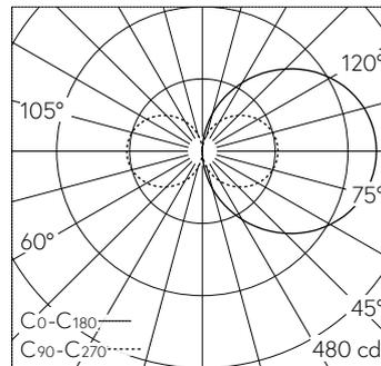
LED 3000 K 19.5 W 1703 lm-h / CIE Flux 14 38 67 50 100 / C11 nach DIN 5040
