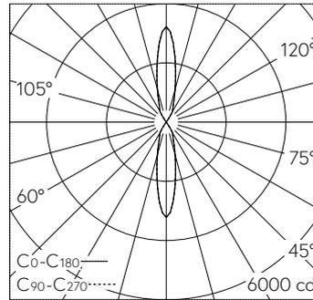
LED 3000 K 26.6 W 2446 lm-h 22° / CIE Flux 100 100 100 50 100 / C84 nach DIN 5...
