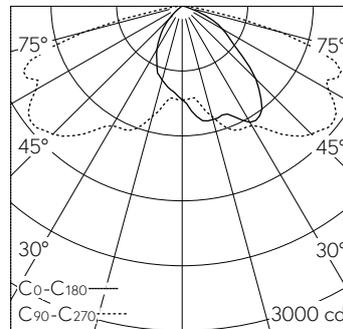
LED 3000 K 35.2 W 4195 lm-h / CIE Flux 38 75 96 100 100 / A30 nach DIN 5040
