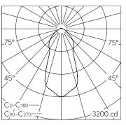
LED 3000 K 39.3 W 3278 lm-h 46° / CIE Flux 64 88 97 94 100 / A52 nach DIN 5040
