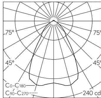
LED 3000 K 4.1 W 301 lm-h 66° / CIE Flux 73 92 98 96 100 / A62 nach DIN 5040
