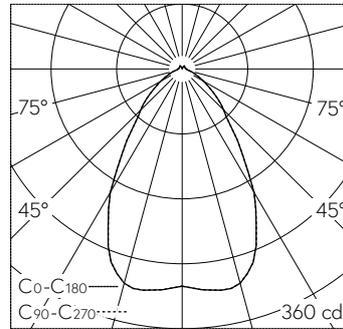
LED 3000 K 5.4 W 495 lm-h 68° / CIE Flux 70 91 97 94 100 / A62 nach DIN 5040
