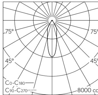
LED 3000 K 20 W 2054 lm-h / CIE Flux 83 89 95 97 100 / A71 nach DIN 5040
