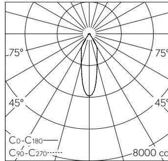
LED 3000 K 20 W 2052 lm-h / CIE Flux 83 89 95 97 100 / A71 nach DIN 5040
