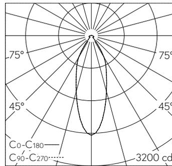
LED 3000 K 16 W 1460 lm-h / CIE Flux 82 89 96 97 100 / A71 nach DIN 5040
