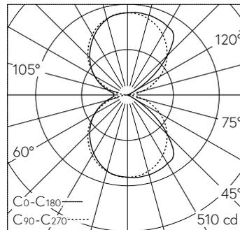
LED 3000 K 31 W 1705 lm-h / CIE Flux 50 82 95 50 100 / C43 nach DIN 5040
