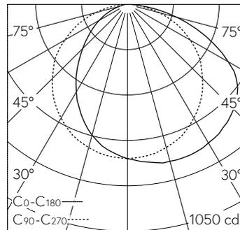
LED 3000 K 24.8 W 2113 lm-h / CIE Flux 46 78 95 100 100 / A40 nach DIN 5040
