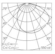
LED 3000 K 16.5 W 1008 lm-h / CIE Flux 45 77 95 100 100 / A40 nach DIN 5040
