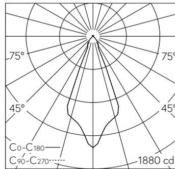
LED 3000 K 28.4 W 793 lm-h / CIE Flux 94 100 100 93 100 / A83 nach DIN 5040
