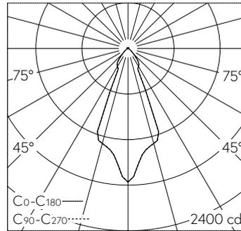
LED 3000 K 28.4 W 1045 lm-h / CIE Flux 89 99 100 95 100 / A83 nach DIN 5040
