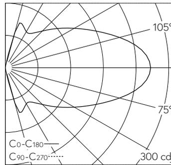
LED 3000 K 28.4 W 448 lm-h / CIE Flux 14 36 63 50 100 / C11 nach DIN 5040
