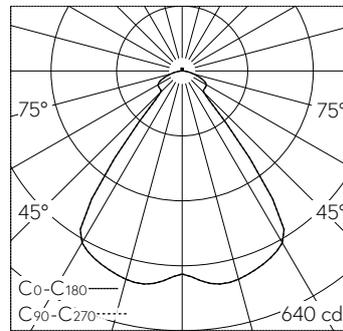
LED 3000 K 18.2 W 895 lm-h / CIE Flux 76 89 98 99 100 / A64 nach DIN 5040
