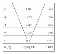
LED 3000 K 13,5 W 1029 lm-h 44° / CIE Flux 0 0 0 0 100 / E84 nach DIN 5040
