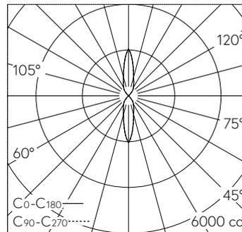
LED 3000 K 120 W 10980 lm-h / CIE Flux 93 98 100 50 100 / C84 nach DIN 5040
