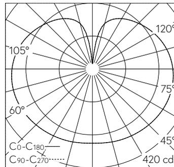
LED 3000 K 39.5 W 3949 lm-h / CIE Flux 24 49 74 54 100 / C12 nach DIN 5040
