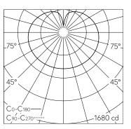
LED 3000 K 65 W 7556 lm-h / CIE Flux 25 50 75 56 100 / C12 nach DIN 5040
