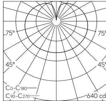
LED 3000 K 26.5 W 2868 lm-h / CIE Flux 25 50 75 56 100 / C12 nach DIN 5040
