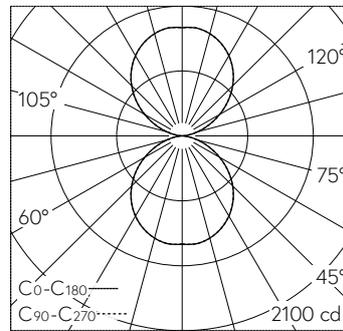
LED 3000 K 94.8 W 6349 lm-h / CIE Flux 50 82 96 50 100 / C43 nach DIN 5040
