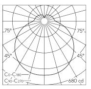
LED 2700 K 33.5 W 2730 lm-h / CIE Flux 39 68 88 79 100 / B32 nach DIN 5040
