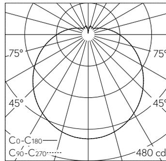
LED 2700 K 19.1 W 1868 lm-h / CIE Flux 37 64 85 81 100 / B31 nach DIN 5040
