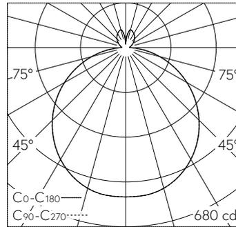
LED 3000 K 18.5 W 1950 lm-h / CIE Flux 45 76 93 89 100 / B43 nach DIN 5040
