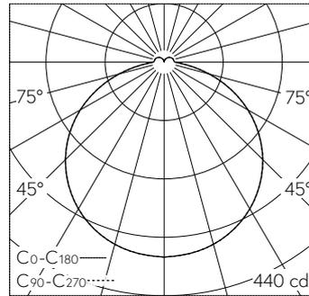
LED 3000 K 16 W 1231 lm-h / CIE Flux 44 76 93 93 100 / A41 nach DIN 5040
