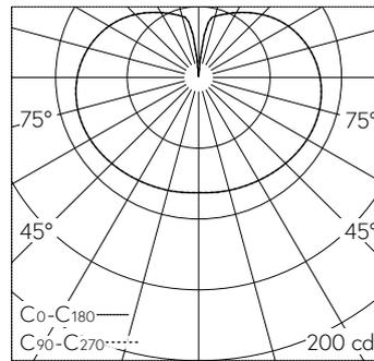
LED 3000 K 10 W 976 lm-h / CIE Flux 24 49 74 55 100 / C11 nach DIN 5040
