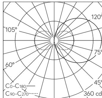
LED 2700 K 14.6 W 1282 lm-h / CIE Flux 14 38 67 50 100 / C11 nach DIN 5040
