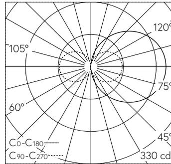
LED 3000 K 12.4 W 1120 lm-h / CIE Flux 14 38 67 50 100 / C11 nach DIN 5040
