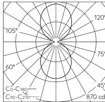
LED 3000 K 26.3 W 2557 lm-h / CIE Flux 54 84 97 49 100 / C53 nach DIN 5040
