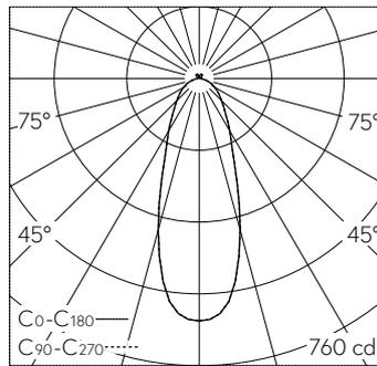
LED 3000 K 10.4 W 570 lm-h / CIE Flux 68 88 97 92 100 / A63 nach DIN 5040
