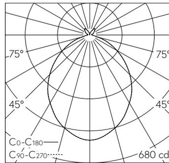
LED 3000 K 13.5 W 1389 lm-h / CIE Flux 54 85 97 90 100 / A53 nach DIN 5040
