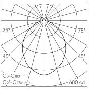
LED 3000 K 13.5 W 1389 lm-h / CIE Flux 54 85 97 90 100 / A53 nach DIN 5040
