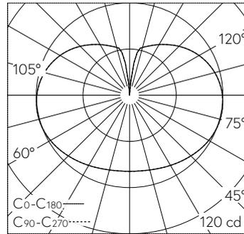
LED 3000 K 8.8 W 893 lm-h / CIE Flux 23 48 73 54 100 / C12 nach DIN 5040
