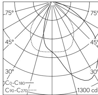
LED 3000 K 13.7 W 1526 lm-h / CIE Flux 60 89 98 100 100 / A50 nach DIN 5040
