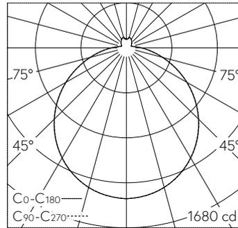
LED 3000 K 48 W 4751 lm-h / CIE Flux 44 74 91 90 100 / A42 nach DIN 5040
